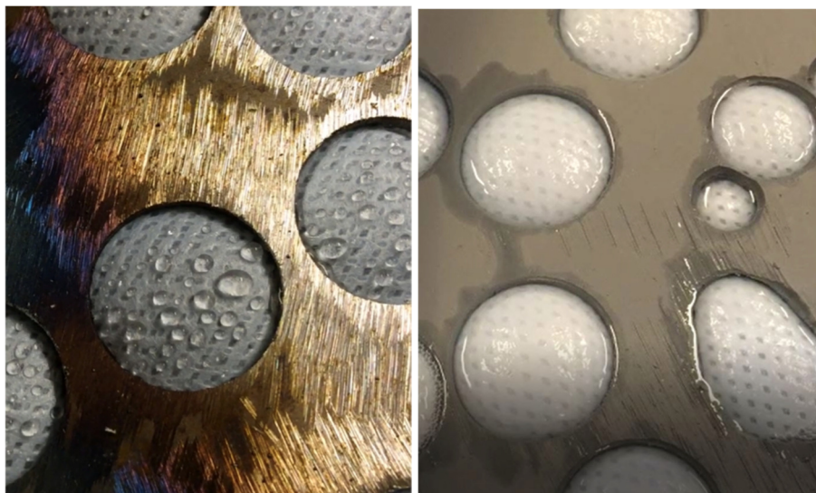
Rent vann som trenger igjennom vindsperre i egenprodusert testapparat
